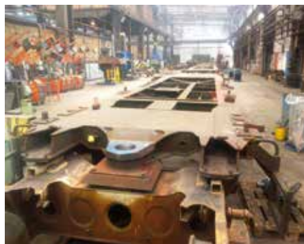
Obr. 3: Opravené ťažné oko podvozku železničného vozňa
