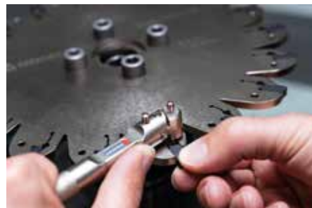
Montáž a demontáž břitových destiček pomocí unikátního klíče převzatého ze systému SX
