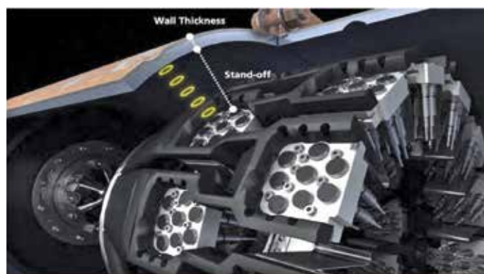
Obr. 2: Princip UT měření
