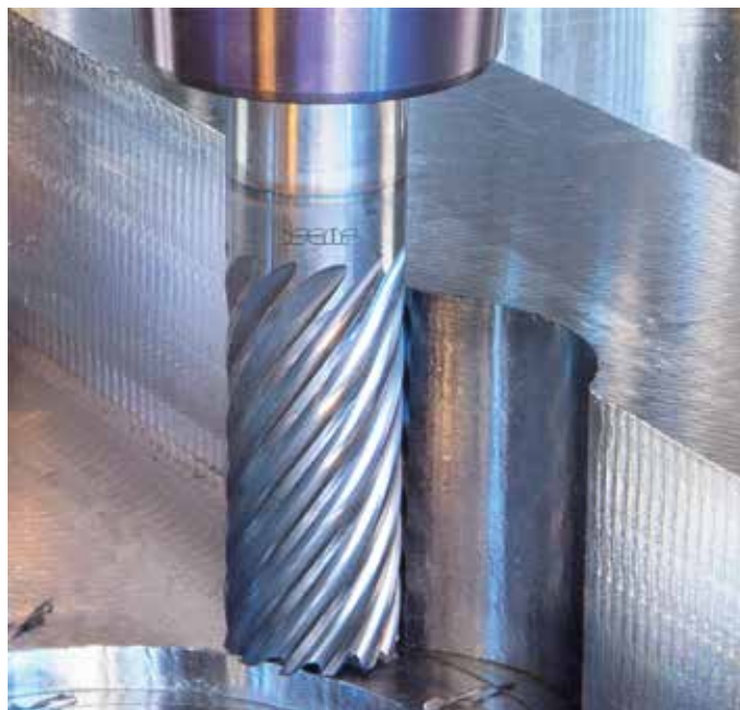
Viaczubá monolitná karbidová stopková fréza určená na vysokorýchlostné obrábanie (HSM).
