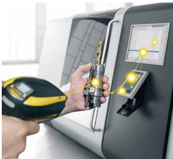
zidCode – přenos dat na stroj pomocí QR kódu
