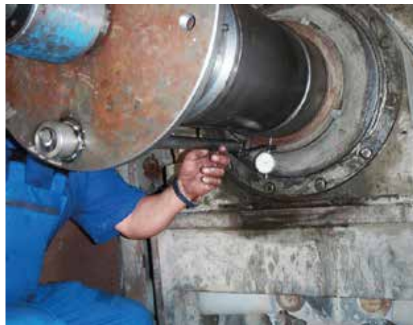
Obr. 4: Meranie hriadeľa s drážkami
