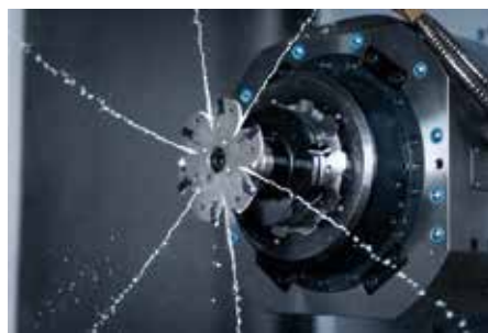
Program kotoučových fréz je v rozsahu průměrů DC80 až DC315
