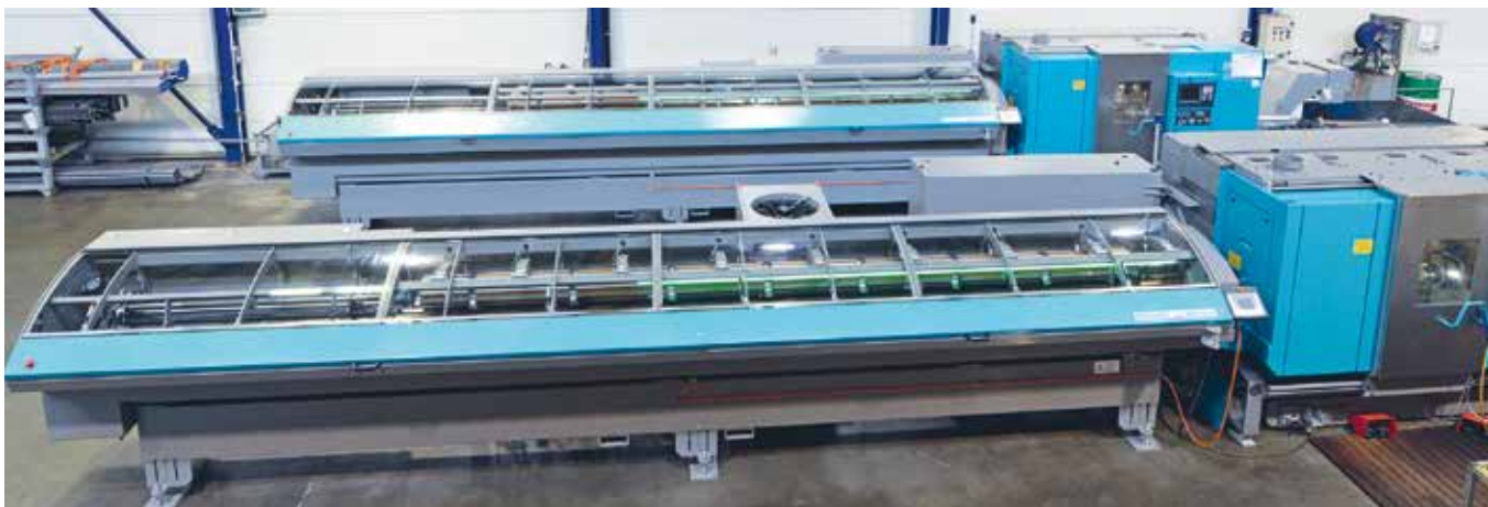
Jednokanálový podávací zásobník IRCO SiMag zakládá 6 000 mm dlouhé tyče
