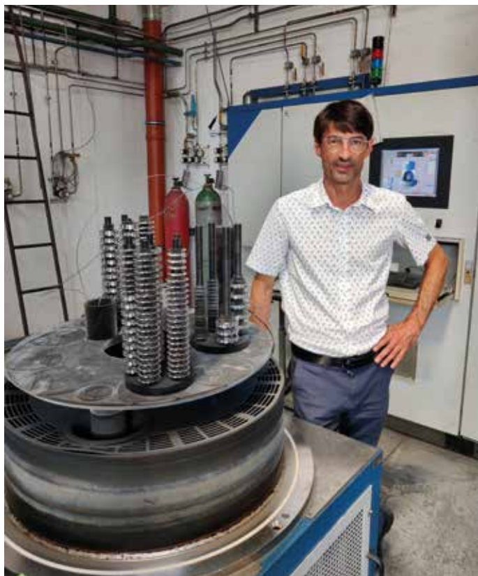
Šaržovanie tvarových fréz – vakuová nitridácia
