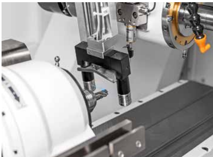
Opce Laser Contour Check od společnosti WALTER s modrým laserovým paprskem
