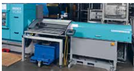
Odebírací automat soustruhu IRCO ILS-REX + ILS-TEX pro délku 1 200 mm hotových výrobků
