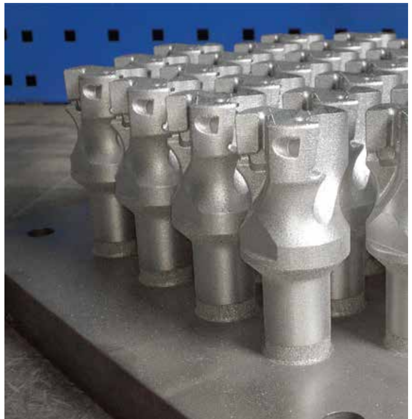
3D tlač kovov – funkčný prototyp telesa frézy, vrátane zložitého tvaru lôžka, vyrobený laserovou technológiou využívajúcou kovy vo forme prášku
