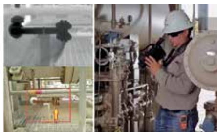
Ukázka vizualizace úniku plynu termokamerou FLIR
