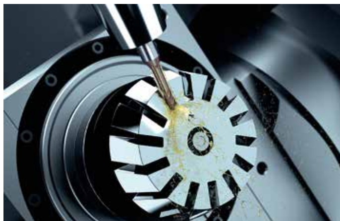
Obrábění rotoru letecké turbíny: Nová torická fréza dosahuje neuvěřitelných řezných dat při hrubování a dokončování v nerezové oceli X12Cr13/1.4006.
