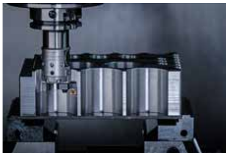
Systém hi.flex-micro nabízí nástroje pokrývající rozsah průměrů od 0,5 do 60 mm
